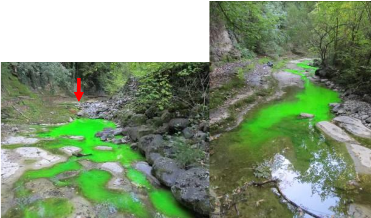
Figure 26 : Point d'injection et propagation du traceur
